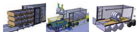
滚筒输送机+吊车
